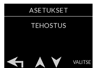
Tehostuksen kesto aika asettelu arvo 0 ja 5...120 min. 0 asennossa erillisen kytkimen kärke tiedolla
