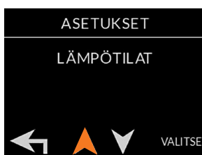
Tuloilman jälkilämmityksen säätö asetusarvo 5...30 °C
